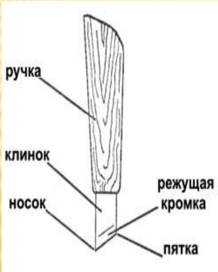
**Ножи-резаки** разных форм применяют при геометрической и контурной резьбе, а также при выполнении изделий в технике прорезной резьбы. Основное предназначение резака — выполнение ровной, прямой канавки.
